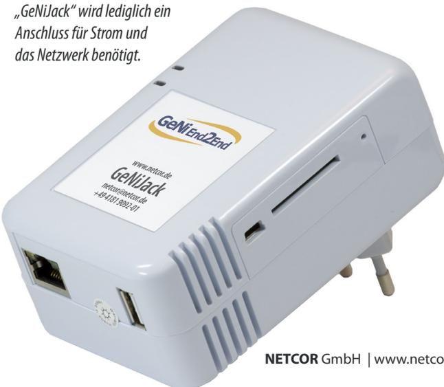
Da Sprache als Echtzeitanwendung höchste Ansprüche an die Übertragungsqualität stellt, ist dieser Parameter besonders geeignet, um die Leistungsfähigkeit einer Verbindung festzustellen. Die eingesetzten Sensoren emittieren beziehungsweise empfangen einen Voice Call und messen dessen Laufzeit, Jitter, Delay und Paketverlust.
